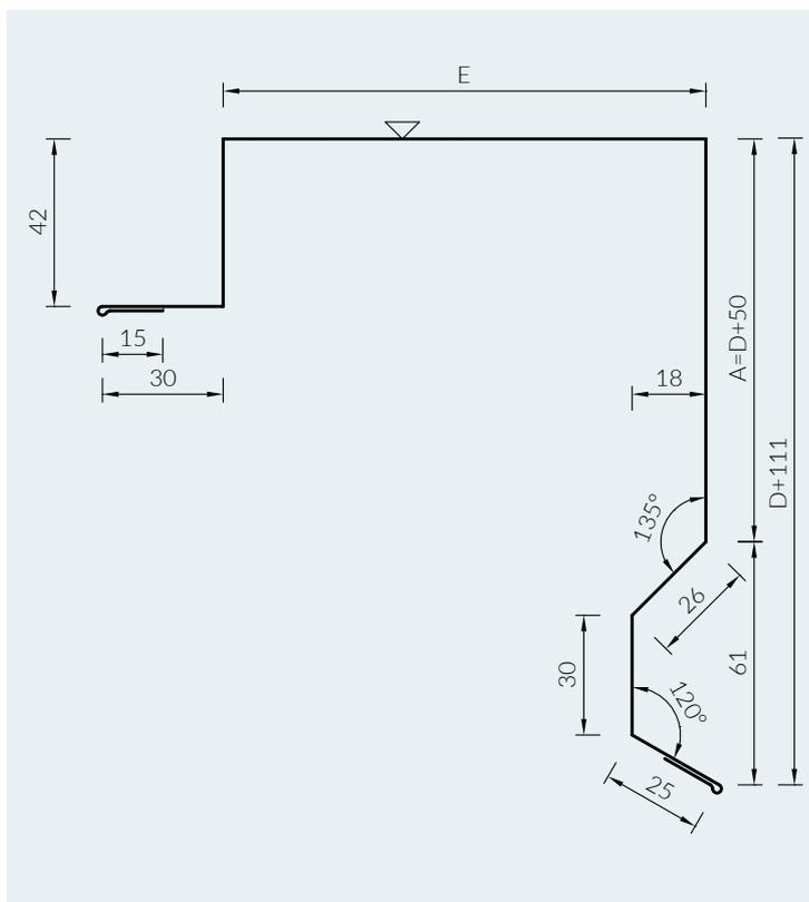
VERWAHRUNG 106 – WINDTRÄGER DER PULTDACH MIT DER DACHTRAUFE
