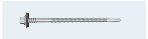
GEWINDEVERBINDER AUS ROSTFREIEM STAHL OHNE BOHRER MIT EPDM-DICHTSCHEIBE Ø 19 MM - ZUR BEFESTIGUNG VON SANDWICHPANEELN AUF STAHL-UNTERKONSTRUKTION AB EINER STÄRKE VON 7 MM
