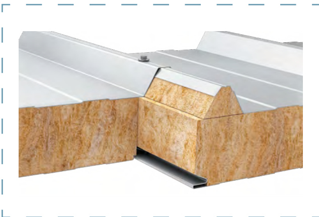
Schema der Paneelverbindung
